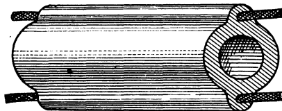
FIG. II-39. — Aspect d'un câble d'émission américain amphérol de 300 \Omega ; notez sa forme cylindrique
