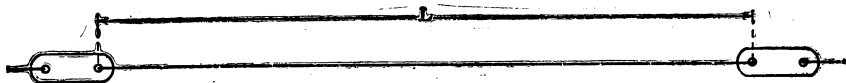
Fig. III-1. — La longueur du brin horizontal est égale à la distance entre les trous des isolateurs
